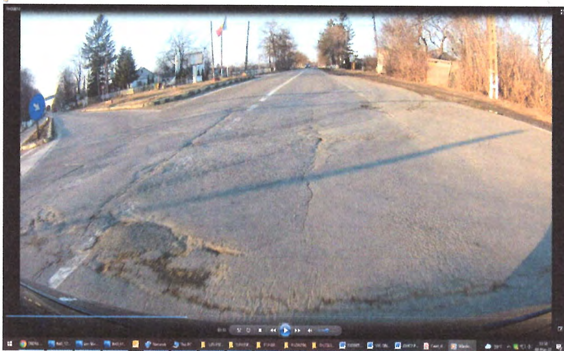
Zona de drum DN29A, zona intersectiei cu DN29C, cu degradari la nivelul imbracamintii rutiere, gropi, cu fisuri si crapaturi pe mai multe directii
